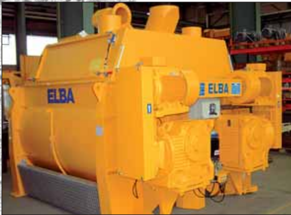
ELBA Doppelwellen-Zwangsmischer EMDW 3000 ELBA Twin-Shaft Compulsory Mixer
